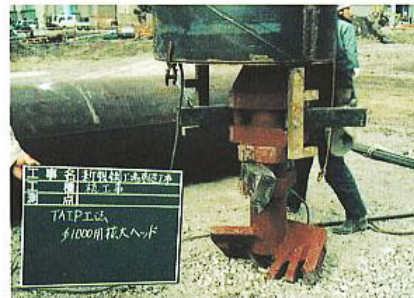
特大径T A I P用ヘッド・ 杭先端F型金具
