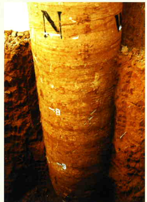
土槽載荷試験後のHYSC杭
